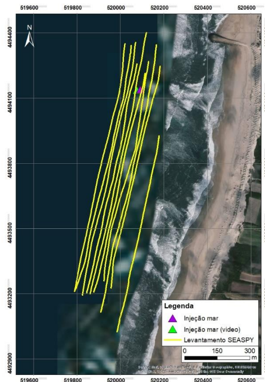
Figura 19 – Localização das fiadas realizadas no dia 11 de julho com magnetómetro SEASPY.
