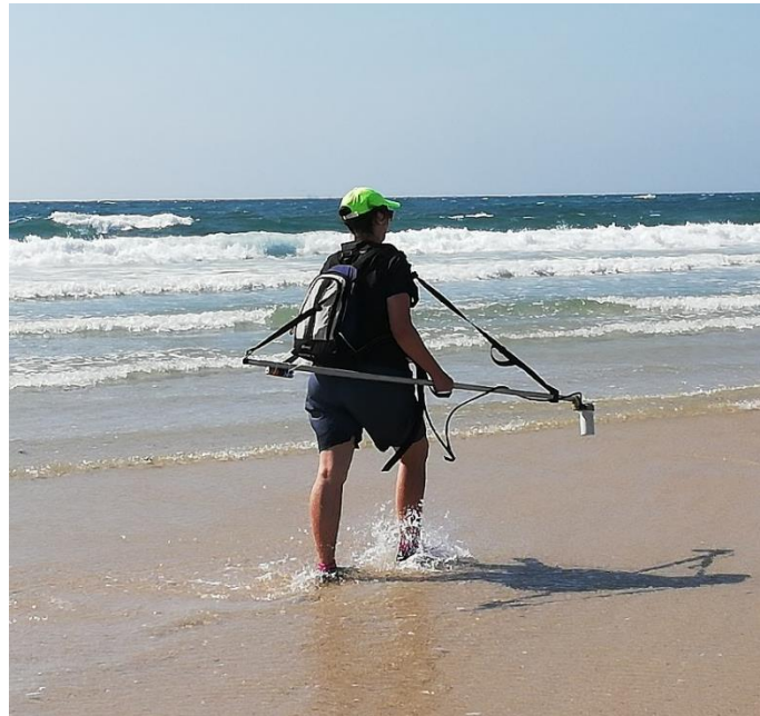
Figura 13 – Medição do campo magnético com o magnetómetro G858
