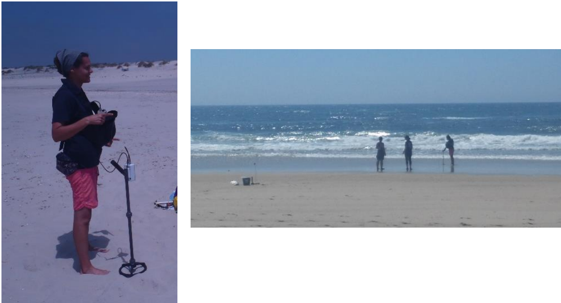
Figura 11 – Medição da suscetibilidade magnética com sensor anelar MS2D
