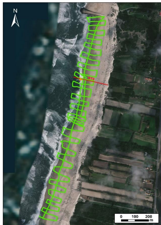
Figura 24 - Levantamento topográfico de referência a pé com DGPS RTK. Está indicado o local de injeção da areia marcada no perfil ST0.
