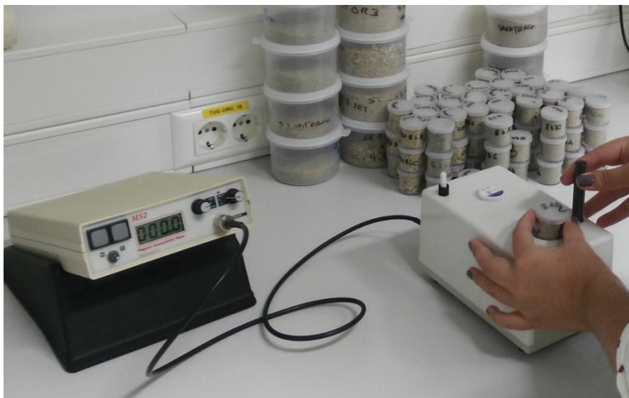
Figura 16 – Medição da suscetibilidade magnética com sensor MS2B.
