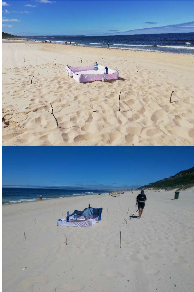
Figura 6 – Em cima uma fotografia da montagem do espaço para a realização do teste, em baixo fotografia do levantamento com o magnetómetro G858.
