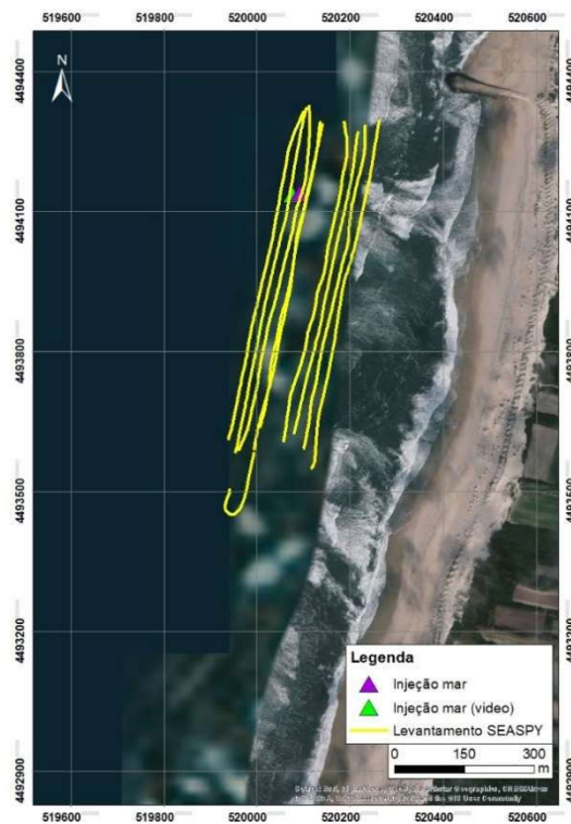
Figura 5 - Localização das fiadas realizadas no dia 12 de julho com o magnetómetro SeaSpy (coordenadas projetadas ETRS89)
