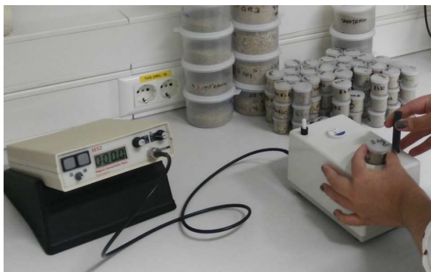
Figura 10 – Medição da SM com o sensor de bancada MS2B.
