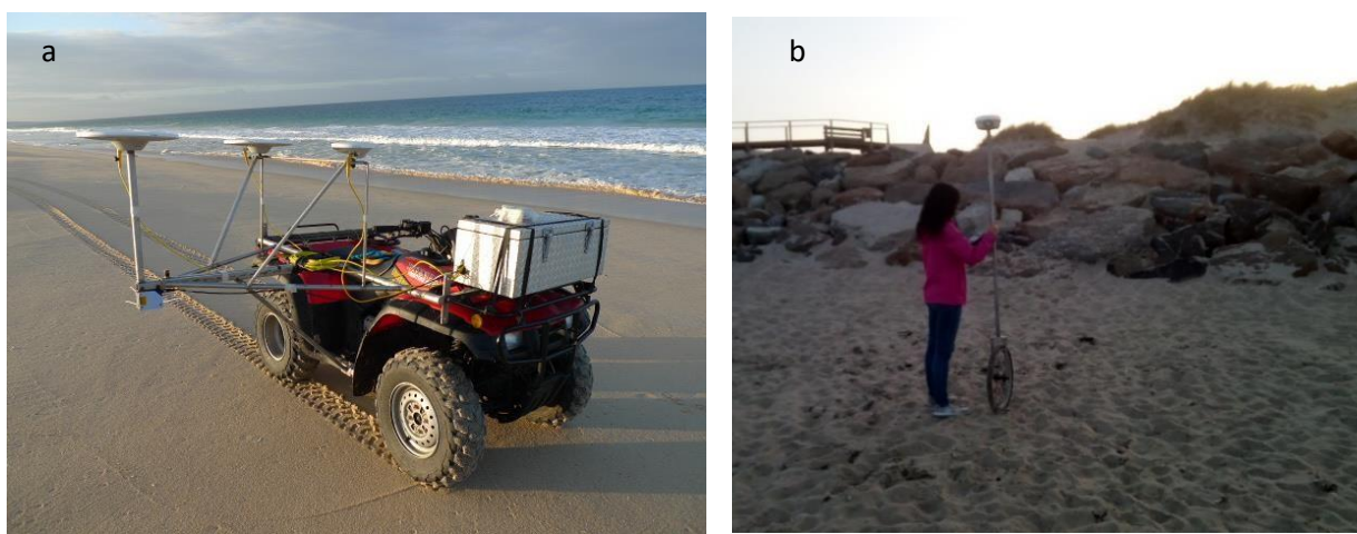
Figura 3 - Fotografias do sistema Inshore instalado na Moto 4 (a) e do monociclo geodésico (b).
