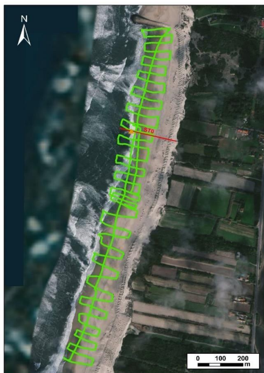
Figura 4 - Levantamento topográfico de referência a pé com DGPS RTK. Está indicado o local de injeção da areia marcada no perfil ST0.
